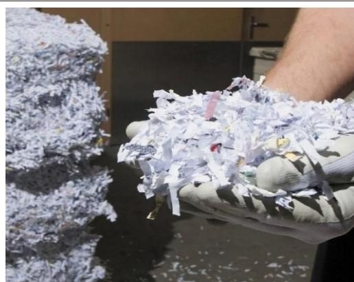
Das Vernichtungsgut wird in mehreren Stufen nach DIN 66399 / ISO/IEC 21964, Stufe 4 (Papier) und Stufe 5 (Datenträger), geschreddert. Eine Rekonstruktion des Inhalts ist technisch nicht mehr möglich. Erst nach diesem Prozess wird das Material nach ökologisch sinnvollen Möglichkeiten dem Recycling zugeführt.
