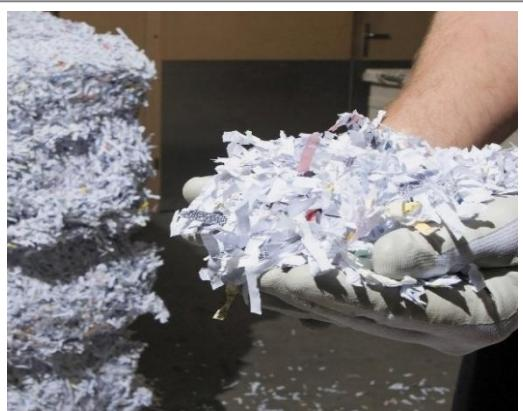
Il processo della distruzione avviene in più fasi secondo la norma DIN 66399/ ISO/IEC 21964, livello 4 (carta) e livello 5 (supporti dati). Una ricostruzione del contenuto è tecnicamente impossibile. Solo dopo questo processo il materiale viene riciclato secondo modalità ecologicamente sostenibili.
